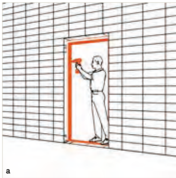
In der nassen Bauphase des Rohbaus wird der neue Türrahmen in die Laibung eingebaut.
