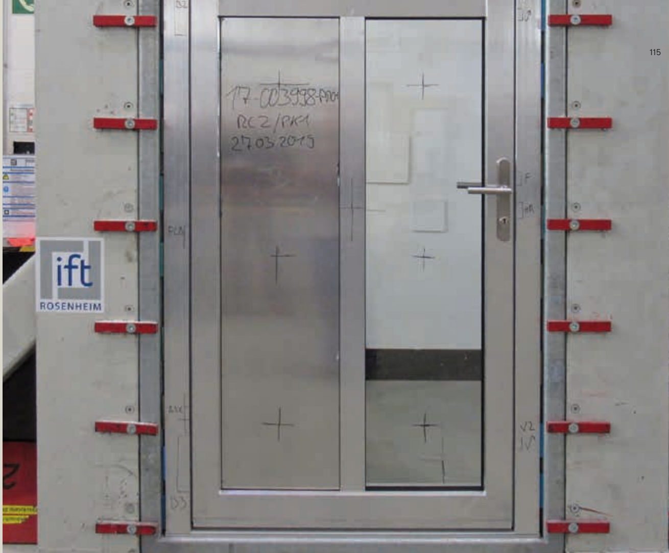
Am Prüfstand untersucht das Institut für Fenstertechnik (ift) Rosenheim die Einbruchsisicherheit von Haustüren.
