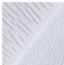
← Geprägte und satinierte Oberfläche in stark vergrößerter Ansicht.
